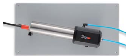
Проточная камера, смонтированная на стене
